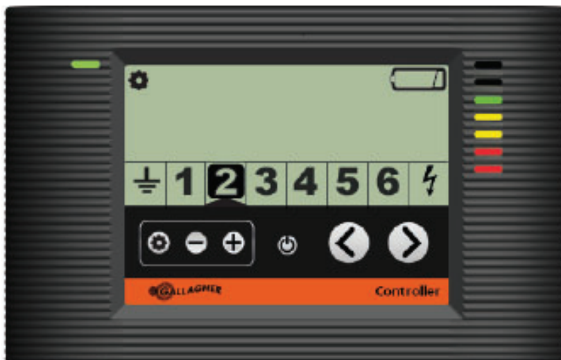
Controlador exibindo a zona 2 com bateria fraca
