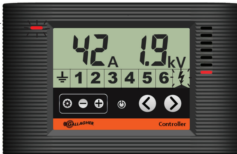
Controlador mostrando el Energizador con alarma de corriente
