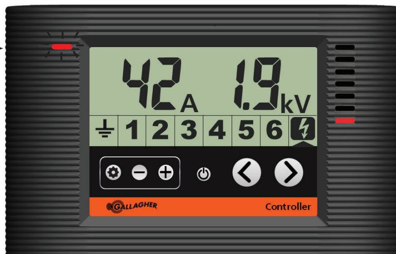
Controlador mostrando o energizador no alarme de saída
