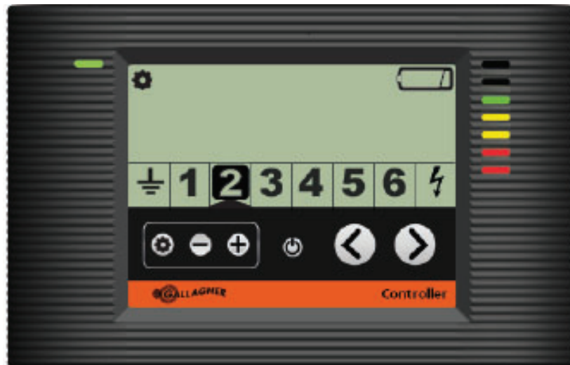
Kontroll visar zon 2 med en låg batterinivå
