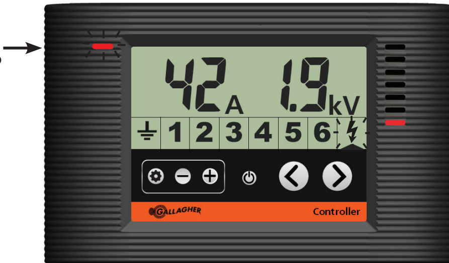
Il display mostra l'elettroficatore in allarme corrente
