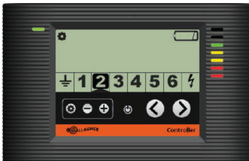
Controlador mostrando la zona 2 con batería baja
