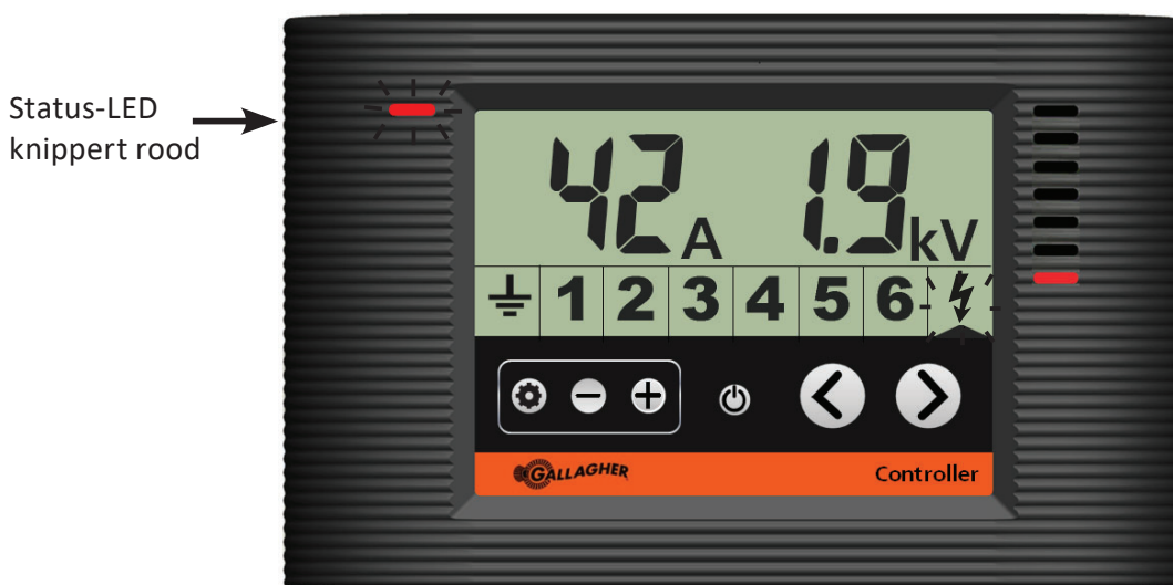
Bedieningspaneel toont het schrikdraadapparaat in stroomsterktealarm
